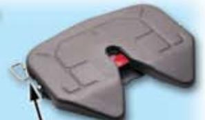
*Position verrouillée - Sur la série 6000 et 7000 No-Slack® la poignée doit être à l'intérieur de 1" du côté de la sellette.*
